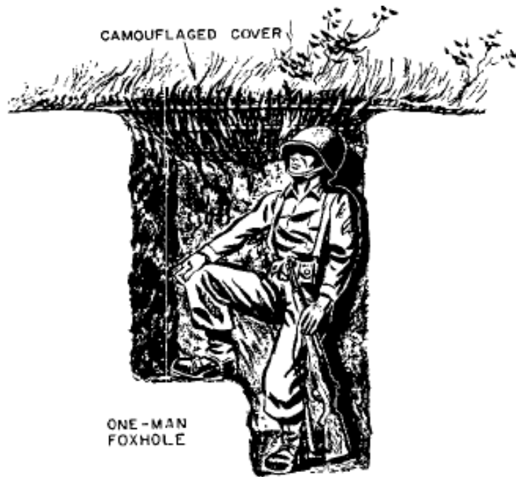
Obr. 4: Zamaskovaný okop pro jednotlivce – řez
