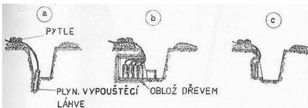
Obr. 208: Umístění plynových vypouštěcích lahví
