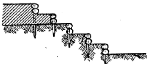
Obr. 56: Obložení schodů dvěma vrstvami fašín
