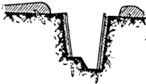
Obr. 55: Obložení stěn zákopu ocelovým pletivem (tahokov)
