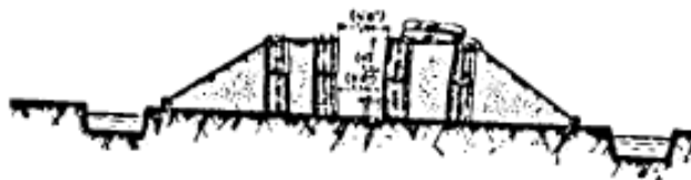
Obr. 44: Zákop vybudovaný v terénu s vysokou hladinou spodní vody
