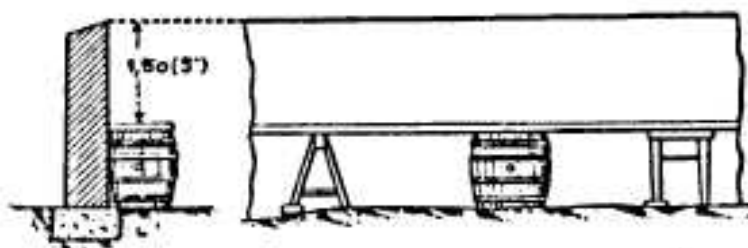
Obr. 32: Střelecké postavení za zdi o výšce překračující 240 cm. Ve zdi nejsou proraženy střílny.
