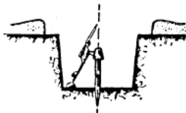
Obr. 160: Kulometné postavení pro palbu proti letadlům – kulomet je připevněn na centrálním pivotu
