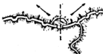
Obr. 157: Schéma typického umístění dvoustřílnové železobetonové pevnůstky pro boční palbu
