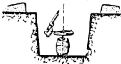
Obr. 161: Kulometné postavení pro palbu proti letadlům – kulomet je upevněn na dřevěném kole a dřevěném sudu
