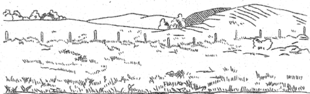
Obr. 32: Klamná překážka. Je tvořena pouze zatlučenými kůly. Při pohledu z větší vzdálenosti budí dojem jednořadé překážky z ostnatého drátu.
