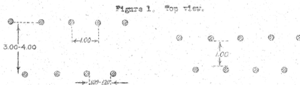
Obr. 126: Nízká překážka z ostnatého drátu Čas na dokončení: 100 m 2 – 8 hod
