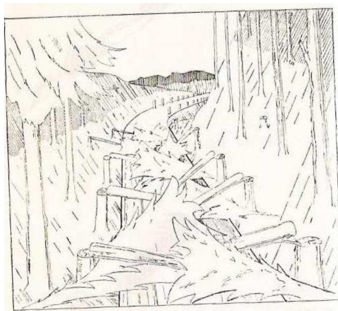
Obr. 166: Těžký stromový zásek na komunikaci
