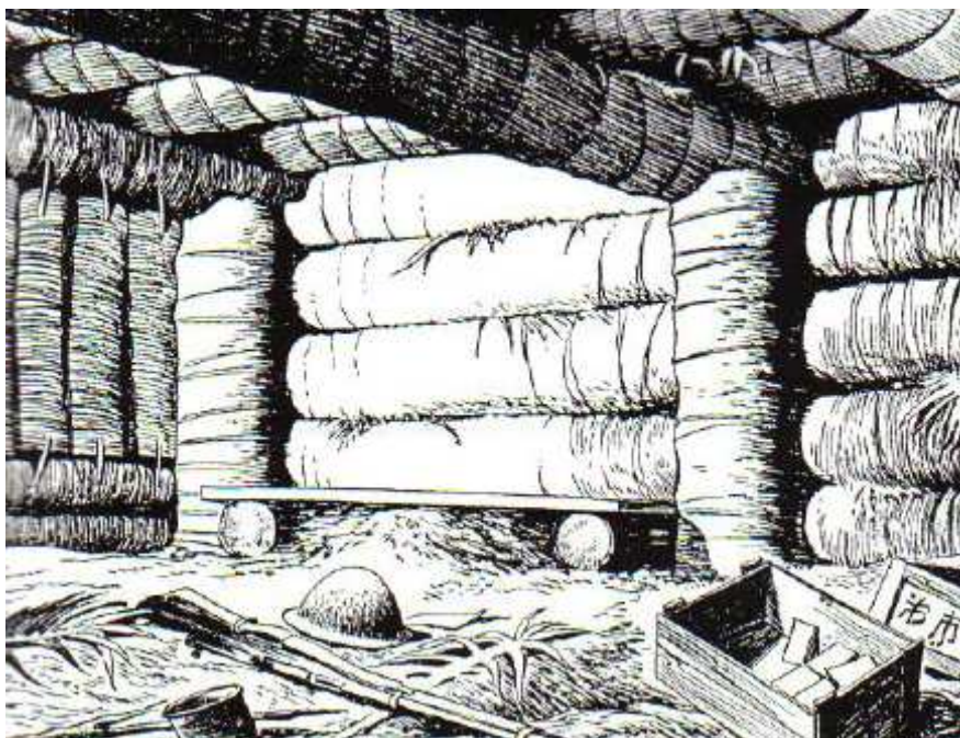
Obr. 43: Interiér pevnůstky vybudované z klád. Vlevo nahoře (i dole) je vidět ocelové skoby, pomocí kterých byly klády vzájemně spojeny
