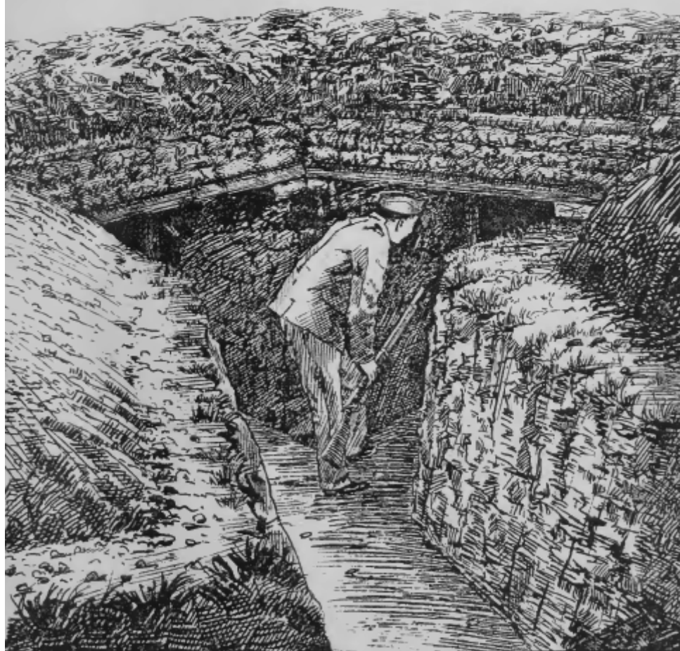
Obr. 10: Střelecká pozice se zemním nakrytím
