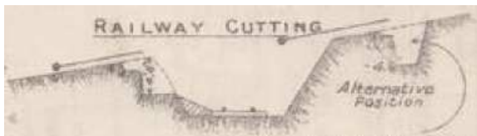
Obr. 11: Obrana terénních zářezů (konkrétně zářezu pro železniční trať). Jsou zde naznačeny obě možnosti umístění palebných postavení.
