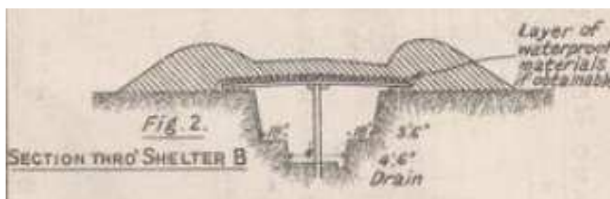
Obr. 27b: Řez nakrytým zákopem pro ukrytí záloh
